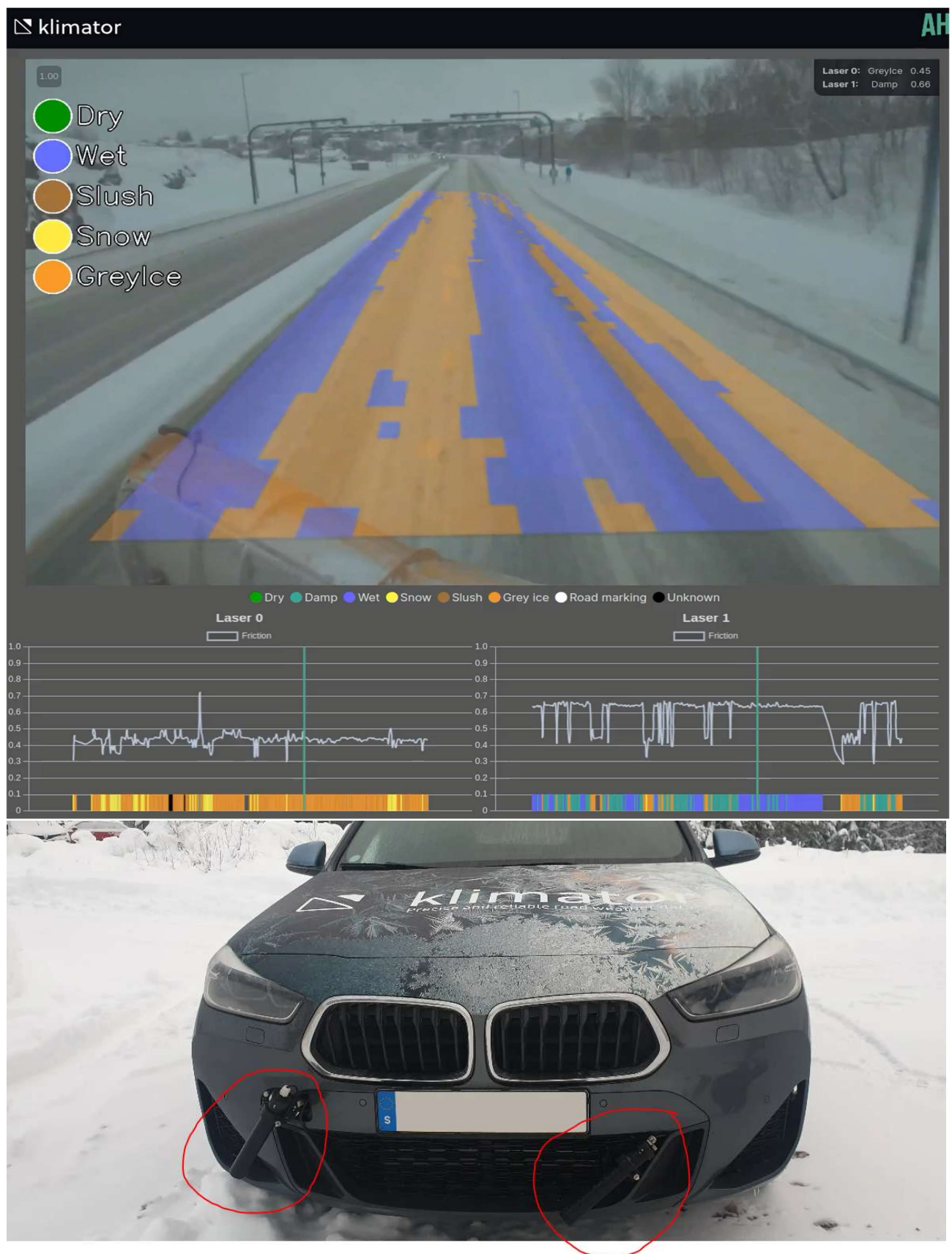
Figur 3, Klimator AHEAD, Computer Vision kombinerat med två väglagsgivare, en i vägmitt samt en höger hjulspår för att kunna tolka väglag korrekt på hela vägens bredd.
